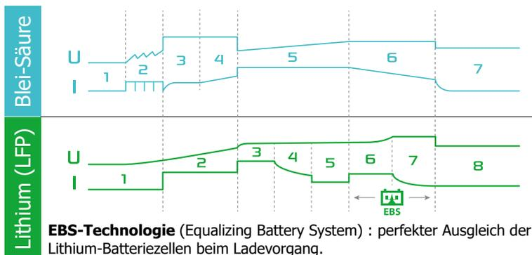
Spezifischer Ladezyklus in 7 Stufen, ohne Überwachung.
