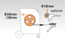
**OPTIONALE ERWEITERUNG** - Die T1 GYS AUTO kann mit einem Spool Gun Brenner ausgestattet werden. Dieser motorisierte Brenner ist kompatibel mit Drahtrollen ø 100 aus Aluminium, Edelstahl, Kupfer oder Stahl für ø 0,8mm.
