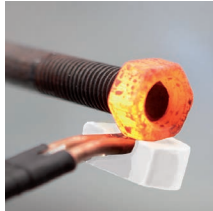
Løsne rustne bolter
