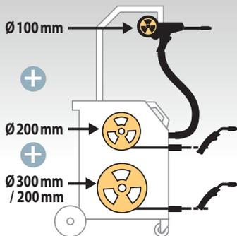
**2 горелки, 2 встроенных подающих механизма + 1 горелка Spool Gun** - делают M3 GYS AUTO многофункциональным сварочным центром с возможностью работы тремя различными типами проволок как по составу, так и по диаметру. Больше не требуется разбирать горелку и переставлять проволоку для разных применений.
