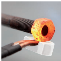
Lossar rostiga skruvar
