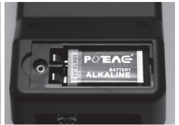
将新的9V电池装入电池槽
