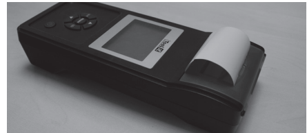
C. 装入后预先抽出部分卷纸，然后关闭透明盖。
