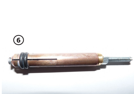
Kobberbunden har 4 slidser og er dedikeret til M4 nitter
