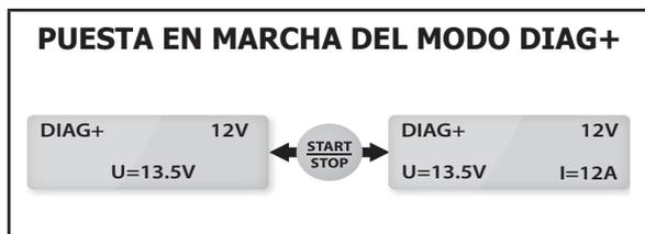
**Precaución:** Si se indica una corriente superior a 10A, esto significará que su batería está descargada. Su Gysflash suministrará una corriente de recarga. Compruebe que no haya dispositivos encendidos en el vehículo. Espere a que la intensidad pase por debajo de 10A para iniciar la operación de diagnóstico.
