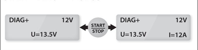
**Vorsicht :** Ist der angezeigte Strom höher als 10A ist die Batterie entladen. Das GYSFLASH wird automatisch einen Ladevorgang beginnen. Prüfen Sie, ob alle elektrischen Verbraucher im Fahrzeug ausgeschaltet sind. Warten Sie, bis der Strom unter 10 A liegt, ehe Sie die Diagnose durchführen.
