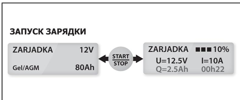
**NB :** В конце зарядки (100%) зарядное устройство поддерживает заряд батареи с помощью напряжения floating. Меры предосторожности : в случае с открытыми АКБ, проверьте уровень электролита. При надобности долийте жидкости перед зарядкой.
