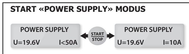
**BEMERKUNG:** Im Gegensatz zu den anderen Modi, wird beim «Power Supply» Modus nicht der Spannungsabfall in den Kabeln ausgeglichen. In dem Fall entspricht die Spannung auf dem Display der Ausgangsspannung vom Gerät (und nicht die Spannung an den Klemmen).
