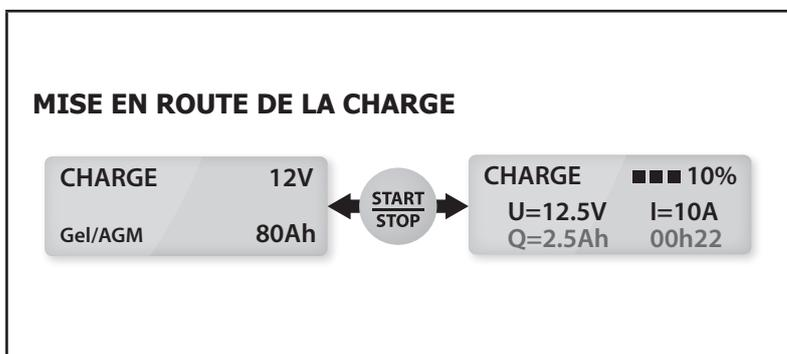
NB : En fin de charge (100%), le chargeur maintient le niveau de charge de la batterie en appliquant une tension de floating.
