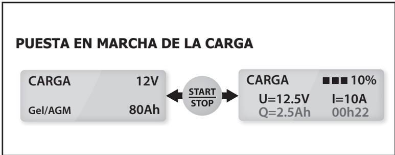
Nota: Al final de la carga (100%), el cargador mantiene el nivel de carga de la batería aplicando una tensión tipo floating.
