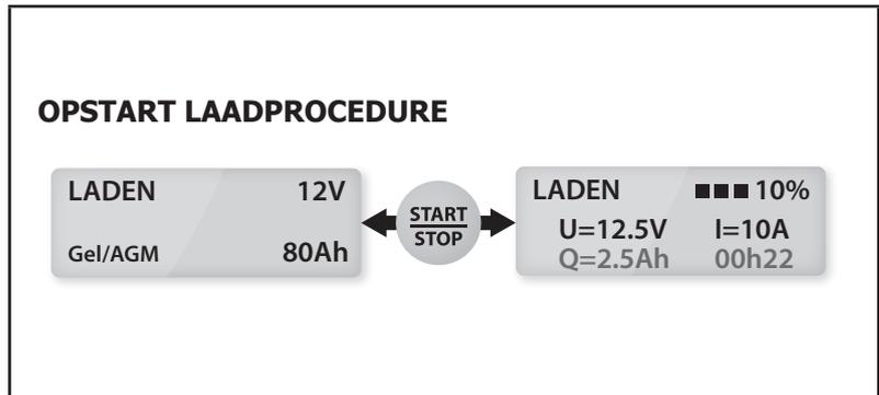
NB : Aan het eind van de laadprocedure (100%) handhaaft de oplader het maximale opladingsniveau met behulp van het floating-system.
