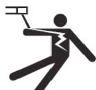
Urządzenie musi być podłączone do gniazda z uziemieniem. Użyj zalecany rozmiar bezpiecznika.
