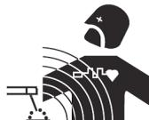
Prądy elektryczne przepływające przez przewodnik powodują tworzenie pól elektrycznych i magnetycznych (EMF). Prąd spawania generuje pole EMF wokół obwodu elektrycznego i wokół urządzenia spawalniczego.
