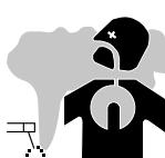
Při plazmatickém řezání dochází k vývinu spalin příp. toxicích výparů, které mohou způsobit nedostatek kyslíku ve vdechovaném vzduchu. Proto vždy zajistěte přívod dostatečného množství čerstvého vzduchu a instalujte odsávání (nebo použijte schválený dýchací přístroj). Řezání provádějte pouze v řádně větraných halách, ve volném prostoru nebo v uzavřených prostorách s intenzivním odsáváním, v souladu s aktuálně platnými bezpečnostními normami.
