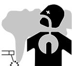
溶接時に発生するヒューム、ガス、粉塵は健康に害を及ぼします。十分な換気を行う必要があり、空気供給手段を増やすことが必要な場合もあります。換気が十分でない場合には、空気を供給するマスクを使用することもできます。
