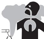
Kouř vznikající při svařování obsahuje škodlivé plyny a výpary. Zajistit dostatek čerstvého vzduchu, může být nutné používat způsobilý dýchací přístroj. Pokud nedostačuje větrání, použijte ochrannou dýchací kuklu s přívodem vzduchu.
