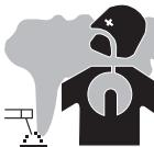
I fumi, gas e polveri emesse dalla saldatura sono pericolosi per la salute. È necessario prevedere una ventilazione sufficiente e a volte è necessario un apporto d'aria. Una maschera ad aria fresca potrebbe essere una soluzione in caso di aerazione insufficiente.
