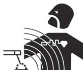
Prąd elektryczny przechodzący przez jakikolwiek przewodnik wytwarza zlokalizowane pola elektryczne i magnetyczne (EMF). Prąd spawania wytwarza pole elektromagnetyczne wokół obwodu spawalniczego i sprzętu do spawania.
