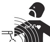
Průchod elektrického proudu v některých vodivých částech způsobuje vznik lokalizovaných elektromagnetických polí (EMF). Svařovací proud způsobuje elektromagnetickou poli v okolí svařovacího obvodu.
