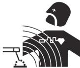
Der durch Leiter fließende elektrische Strom erzeugt lokale elektrische und magnetische Felder (EMF). Beim Betrieb von Lichtbogenschweißanlagen kann es zu elektromagnetischen Störungen kommen.
