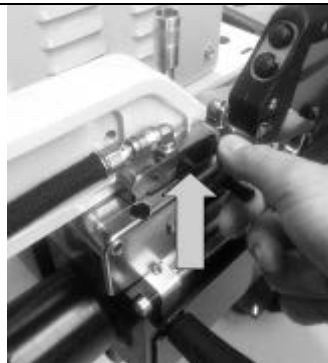
2. Поднимите рычаг D, чтобы разблокировать плечо.
