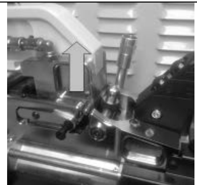
3. Переместите плечо назад и приподнимите его, чтобы убрать опору.
