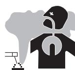
Beim Schweißen entstehen Rauchgase bzw. toxische Dämpfe, die zu Sauerstoffmangel in der Atemluft führen können. Sorgen Sie daher immer für ausreichend Frischluft, technische Belüftung (oder ein zugelassenes Atmungsgerät).
