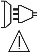
To urządzenie nie jest zgodne z normą IEC 61000-3-12 i jest przeznaczone do podłączenia do prywatnych sieci niskiego napięcia podłączonych do publicznej sieci zasilającej tylko na poziomie średniego i wysokiego napięcia. W przypadku podłączenia do publicznej sieci zasilającej niskiego napięcia obowiązkiem instalatora lub użytkownika sprzętu jest upewnienie się, poprzez konsultacje z operatorem sieci dystrybucyjnej, że sprzęt może zostać podłączony.
