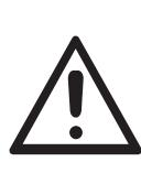
Il gas uscendo dalle bombole potrebbe essere fonte di soffocazione in caso di concentrazioni in spazi di saldatura (ventilare correttamente).
