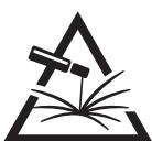
Scherf het lasgebied volledig af, brandbare stoffen moeten minimaal op 11 meter afstand geplaatst worden.
