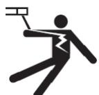
Das Schweißgerät darf ausschließlich an einer geerdeten Netzversorgung betrieben werden. Verwenden Sie nur die empfohlenen Sicherungen.
