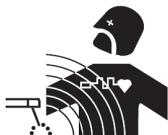
Prąd elektryczny przepływający przez jakikolwiek przewodnik wytwarza lokalne pola elektryczne i magnetyczne (EMF). Prąd spawania wytwarza pole elektromagnetyczne wokół obwodu spawalniczego i urządzenia spawalniczego.
