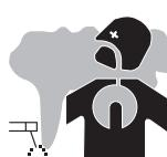
Pri zavarivanju nastaju dimni plinovi odnosno otrovne pare, koje mogu dovesti do nedostatka kisika u zraku koji se diše. Stoga se uvijek pobrinite za dovoljno svježeg zraka, tehničku ventilaciju (ili dopušteni uređaj za disanje).
