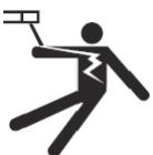
Aparat za zavarivanje smije raditi isključivo na uzemljenom mrežnom napajanju. Rabite samo preporučene osigurače.
