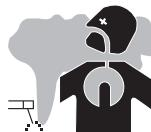
Vid plasmaskärning bildas rökgaser resp. giftiga ångor som kan leda till syrebrist i andningsluften. Därför måste man alltid ombesörja tillräckligt med frisk luft, teknisk ventilation (eller godkänd andningsutrustning). Använd skäraggregaten endast i välventilerade hallar, utomhus eller i slutna rum med ett utsug som uppfyller aktuella säkerhetsstandarder.
