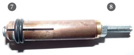
7 Медный наконечник с 4 прорезами для приваривания шпилек М4 (диаметр Ø 4 мм)
