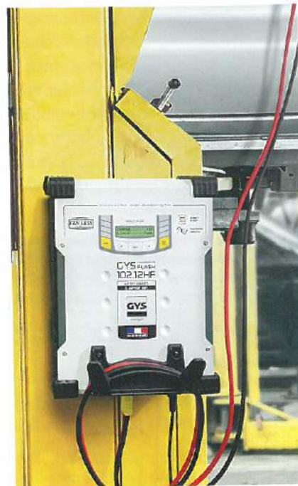
Diagnosehelfer: Mit speziellen Haltern lässt sich das Inverterladegerät ‚GYS Flash 102.02HF‘ von GYS einfach an Hebebühnen, Werkzeugwagen und Werkbänken befestigen – und ist damit bei stromintensiven Fehlersuchen und Update-Vorgängen stets griffbereit. Bild: GYS
