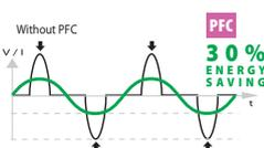
A tecnologia PFC suprime os picos e regula a corrente de alimentação. Também favorece a utilização de extensões ou grupo eletrogêneo e ajuda a obter uma melhor estabilidade da corrente durante a fase de soldadura.
