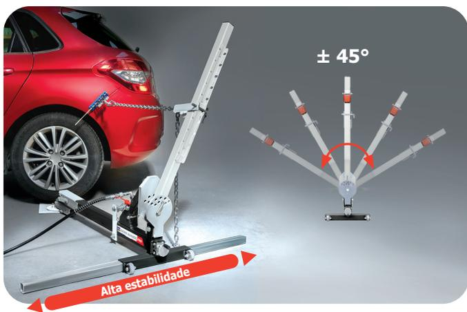
A barra de puxar vertical pode ser inclinada para a esquerda e para a direita, isto permite ajustar a **direcção de puxar a +/- 45°.**
