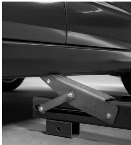
Se il veicolo ha una protezione sotto il telaio, utilizzare la parte metallica mostrata a lato per appoggiare la protezione e bloccare la staffa durante la trazione. Per fare ciò azionare la manovella dietro alla staffa di trazione.
