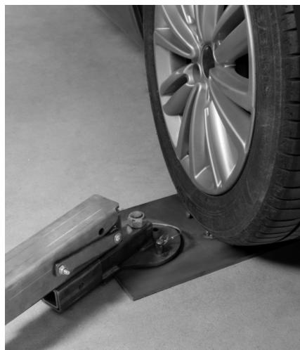
Se la zona da raddrizzare è vicina ad una ruota, è possibile utilizzare la piastra posizionando la ruota del veicolo sulla piastra. La piastra ruota per posizionarsi nell'asse di trazione desiderato. Se necessario, puoi aggiungere supporto utilizzando i bracci telescopici
