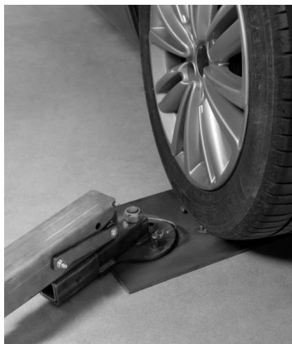
Der Richtausleger Pro verfügt über einen Zugbalken, um den Zugwinkel entsprechend der Zugkonfiguration zu ändern.
