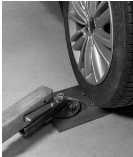
Si la zone à redresser se situe à proximité d'une roue, vous pouvez utiliser la platine en positionnant la roue du véhicule sur la platine. La platine pivote pour se positionner dans l'axe de tirage souhaité. Vous pouvez si besoin rajouter un appui à l'aide des bras télescopique
