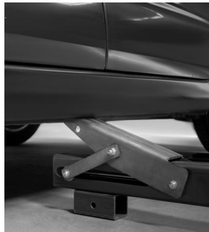
Если участок, подлежащий рихтовке, находится рядом с колесом, можно использовать пластину, установив колесо автомобиля на пластину. Пластина поворачивается для позиционирования на нужной оси вытягивания. При необходимости можно добавить опору с помощью телескопических кронштейнов.
