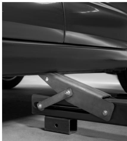
Als de te repareren zone zicht dichtbij een wiel bevindt, kunt u de plaat gebruiken door het wiel erop te plaatsen. De plaat draait, en zal zich positioneren in de gewenste positie. U kunt, indien gewenst, de telescoop-armen toevoegen.
