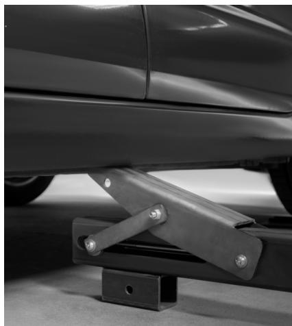
Si la zona a enderezar está cerca de una rueda, puede utilizar la placa colocando la rueda del vehículo sobre la misma. La rueda se puede girar al eje de tracción deseado. Si es necesario, puede añadir soporte con los brazos telescópicos.
