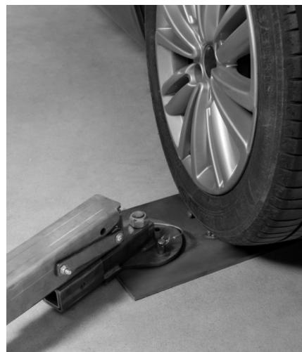
Угловой стапель Pro имеет вращающуюся мачту для изменения угла натяжения для более точной настройки.
