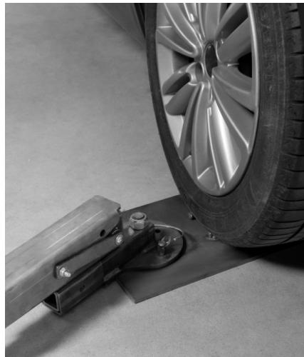
De Trekbalk Pro beschikt over een draaiende is waarmee de trek-hoek kan worden aangepast, om zo een optimale werksituatie te creëren.
