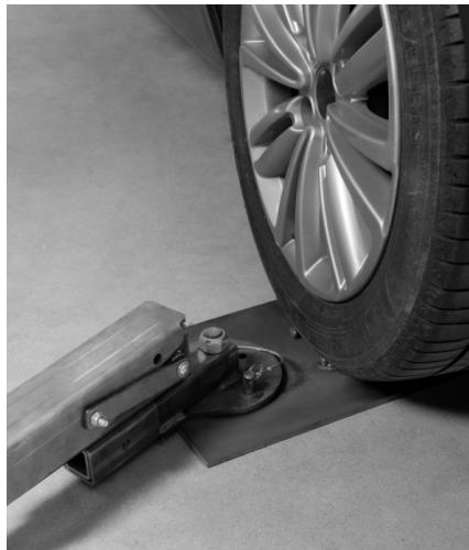
La escuadra de tiro Pro tiene un mástil giratorio que permite cambiar el ángulo de tiro para adaptarse a la configuración de tiro.
