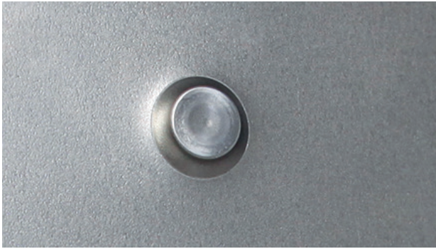
ABBILDUNG STANZNIETVERBINDUNG VORDER- U. RÜCKSEITE
