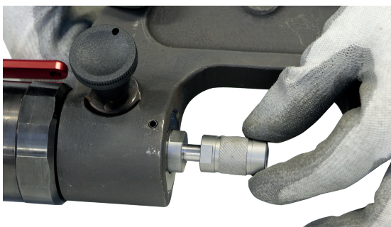
Atornillar la prolongación incluida con el brazo.
