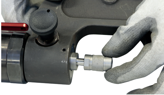
Schrauben Sie den Verlängerungsadapter an den Arm.
