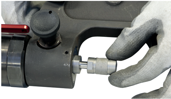
Привинтите насадку, идущую в комплекте с плечом.
