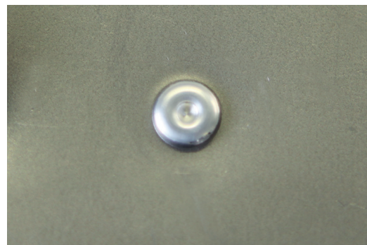
РЕЗУЛЬТАТ УСТАНОВКИ ЗАКЛЕПКИ ТЕКУЩЕЙ ФОРМЫ FLOW-FORM
