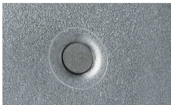
РЕЗУЛЬТАТ УСТАНОВКИ САМОПРОНИКАЮЩЕЙ ЗАКЛЕПКИ
