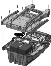
Het apparaat moet gedemonteerd worden wanneer de accu's moeten worden vervangen. Ga als volgt te werk :
