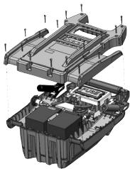
Разобрать аппарат необходимо, например, в случае замены аккумуляторов. Действуйте следующим образом:
