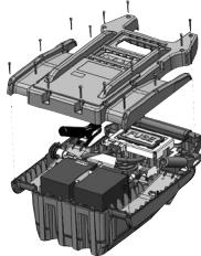
Desmontar el producto es útil para reemplazar las baterías. Proceda como sigue:
