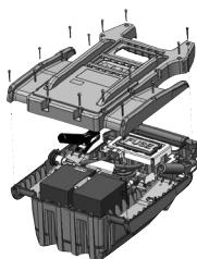
Smontare il prodotto è utile per sostituire le batterie. Procedere come segue :
