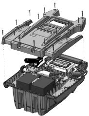
Démonter le produit est utile notamment pour remplacer les batteries. Procéder comme tel :
