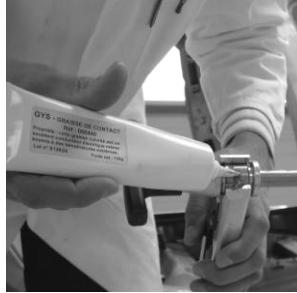
2 Breng wat vet aan aan de binnenkant van de klem en op de stang van uw
