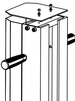
Entfernen Sie die beiden Schrauben auf der Säule und nehmen Sie die Abdeckung ab.
