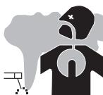
El humo, el gas y el polvo que se emite durante la soldadura son peligrosos para la salud. Hay que prever una ventilación suficiente y en ocasiones puede ser necesario un aporte de aire. Una máscara de aire puede ser una solución en caso de aireación insuficiente.
