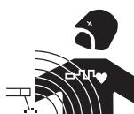
La corriente eléctrica causa campos electromagnéticos (EMF) localizados al pasar por cualquier conductor. La corriente de soldadura produce un campo electromagnético alrededor del circuito de soldadura y del material de soldadura.
