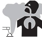
Dampen, gassen en stof uitgestoten tijdens het lassen zijn gevaarlijk voor de gezondheid. Zorg voor voldoende ventilatie, soms is toevoer van verse lucht tijdens het lassen noodzakelijk. Een lashelm met verse luchtaanvoer kan een oplossing zijn als er voldoende ventilatie is.
