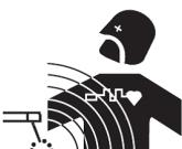
Электрический ток, проходящий через любой проводник, вызывает локализованные электромагнитные поля (EMF). Сварочный ток вызывает электромагнитное поле вокруг сварочной цепи и сварочного оборудования.
