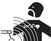
La corrente elettrica passando attraverso a qualunque conduttore prodotto dai campi elettrici e magnetici (EMF) localizzati. La corrente di saldatura produce un campo elettromagnetico attorno al circuito di saldatura e al dispositivo di saldatura.
