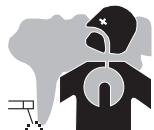
Выделяемые при сварке дым, газ и пыль опасны для здоровья. Вентиляция должна быть достаточной, и может потребоваться дополнительная подача воздуха. При недостаточной вентиляции можно воспользоваться маской сварщика-респиратором.
