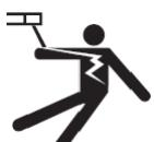
Используемая электрическая сеть должна обязательно быть заземленной. Соблюдайте калибр предохранителя указанный на аппарате.
