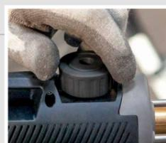
Sostituzione degli accessori rapida e senza attrezzi, grazie alla manopola di blocco/sblocco sulla forcella di tenuta.
